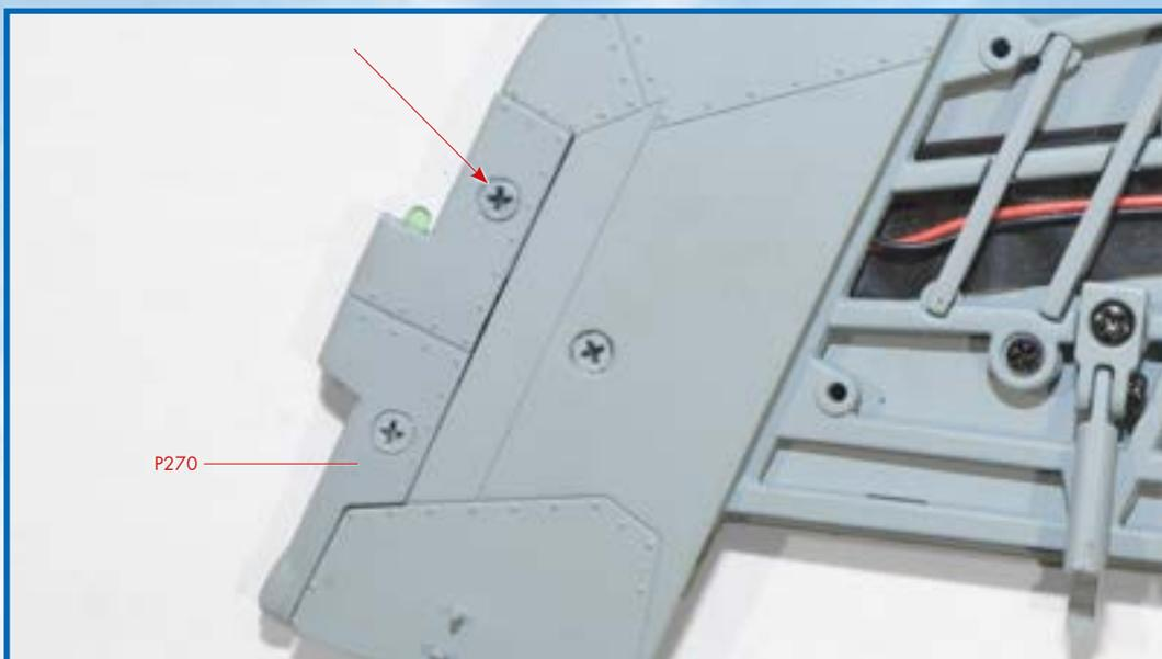
**8** Затем зафиксируйте деталь P270 винтом SM.
