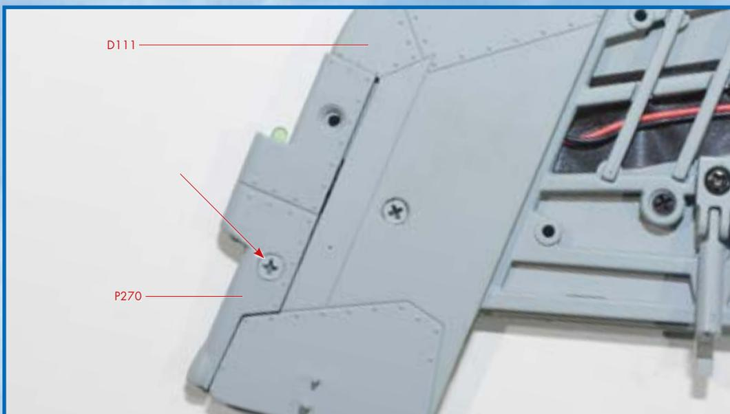
**7** Установите нижнюю часть законцовки крыла (P270), как показано на снимке, и зафиксируйте деталь винтом LP.
