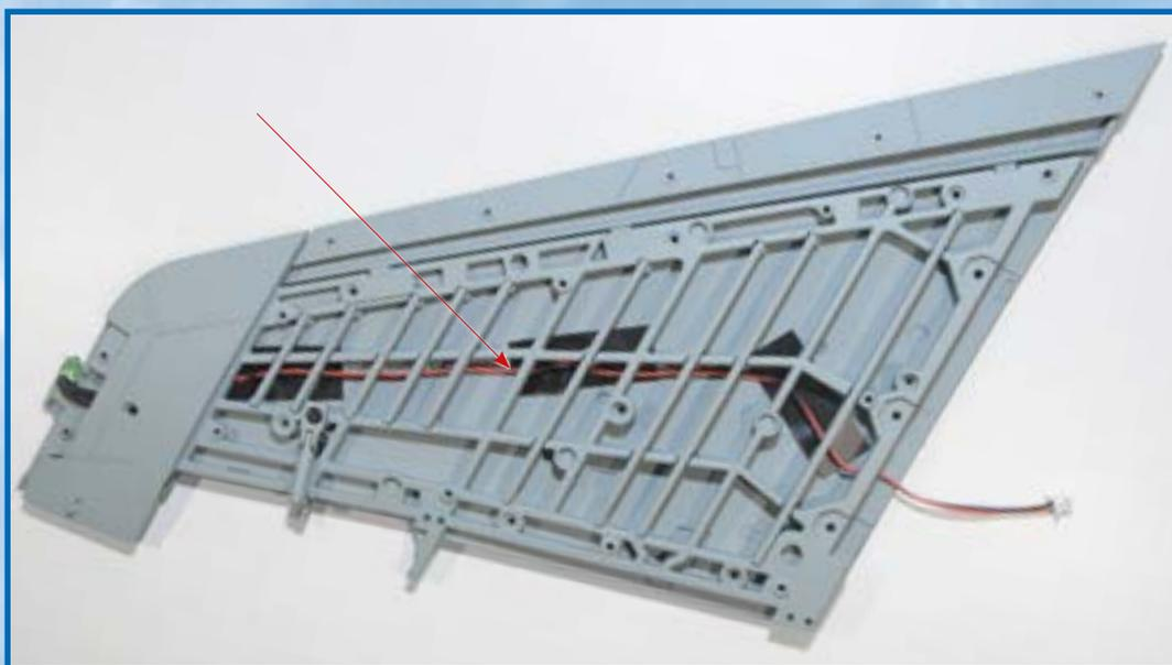
**5** Зафиксируйте обшивку крыла винтами NP, как показано на снимке.
