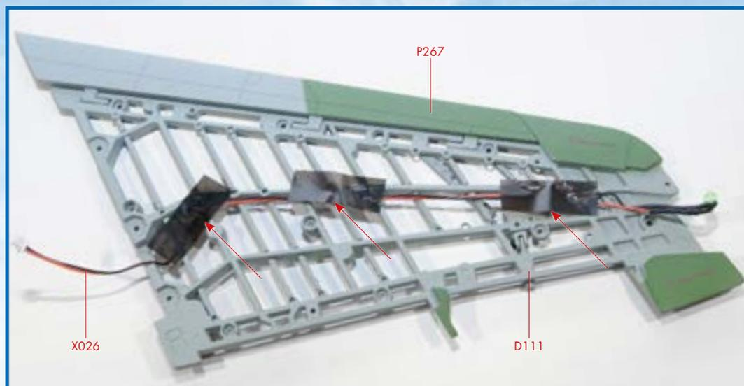
**2** Пропустите провод АНО по каркасу консоли крыла, как показано на снимке. Закрепите провод скотчем. Затем установите носок крыла (P267) на каркас, как показано на снимке.
