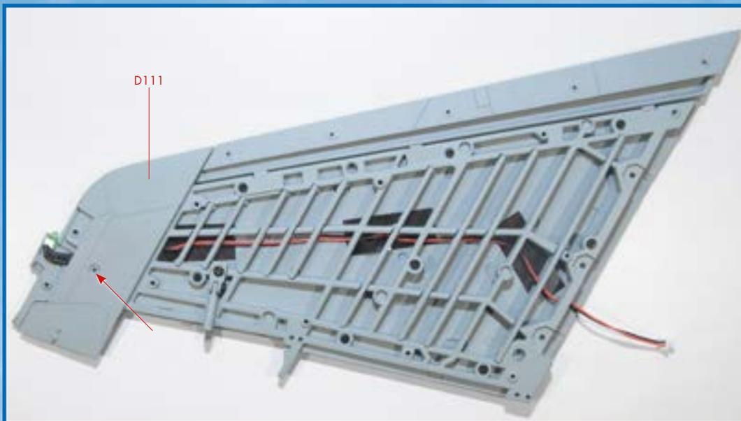
**6** Затем закрепите детали винтом LP, как показано на снимке.
